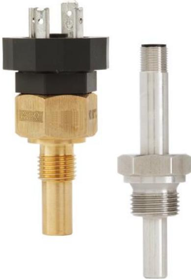
Il TFS135, conforme alla direttiva per bassa tensione della Comunità Europea, è stato progettato per temperature di intervento di +50 °C ... +130 °C, selezionabili a passi in 5 K, e impostate in modo permanente prima della spedizione al cliente. Grazie alla resistenza alle vibrazioni fino a 10 g, il TFS135 vanta un funzionamento affidabile anche in condizioni di esercizio severe. Le connessioni elettriche ne rendono pressoché immediata la messa in servizio.
