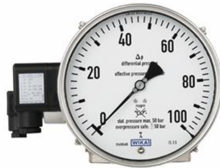
Manometro di pressione differenziale del sistema di misura Cryo Gauge. La seconda uscita elettrica (sul retro) appartiene al trasmettitore da processo integrato per l'indicazione della pressione di esercizio.
