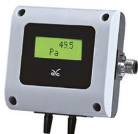
Per il monitoraggio di pressione differenziale di camere bianche, condotte di aria, filtri ambientali etc. Dotato di display, uscita analogica configurabile e RS 485 standard. Possibilità di selezionare le unità ingegneristiche ed estrazione radice quadrata.
