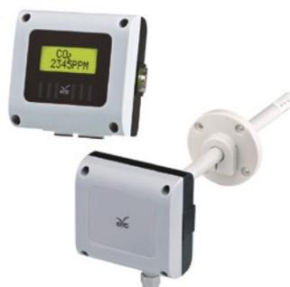
Sviluppato per applicazioni di monitoraggio di qualità dell'aria e risparmio energia, applicato nei sistemi di controllo di ventilazione di edifici, serre, depositi per la conservazione di alimenti. Preciso ed accurato, con capacità di misura fino a 10.000 PPM, è dotato di uscite analogiche in tensione o corrente nonché RS 485 optional. Fornito con software di configurazione gratuito.
