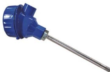
Grado di protezione IP 66, custodia in alluminio e sensore in acciaio inox, sono caratterizzati da elevata precisione di misura ed elevata stabilità a lungo termine. Utilizzati per la misura di temperatura o umidità, o entrambe in aria o altri gas non aggressivi, in zone a rischio esplosione o con presenza di polveri infiammabili.
